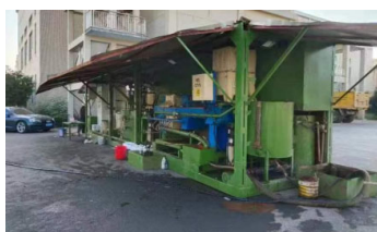
↑ 連續式熱水解污泥處理機演示 ↓ 有餅乾香味、含水 < 40% 的乾泥
