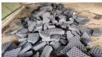
↑ 連續式熱水解污泥處理機演示 ↓ 有餅乾香味、含水 < 40% 的乾泥
